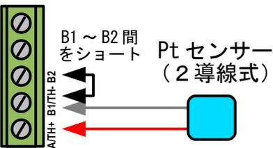
※ 配線が長い場合は3導線式シールド線接続を推奨します。
